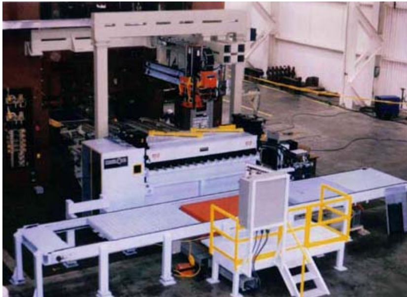
Рисунок 2: Устройство для расстыковки листов
