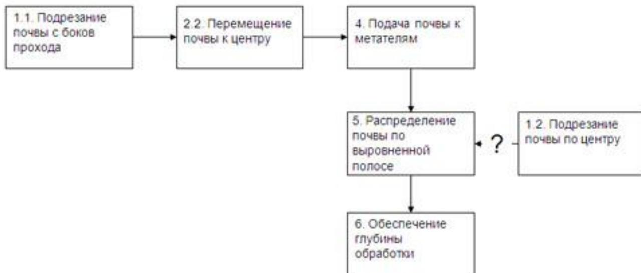
Рис.6. Функционально-идеальная модель процесса выравнивания
