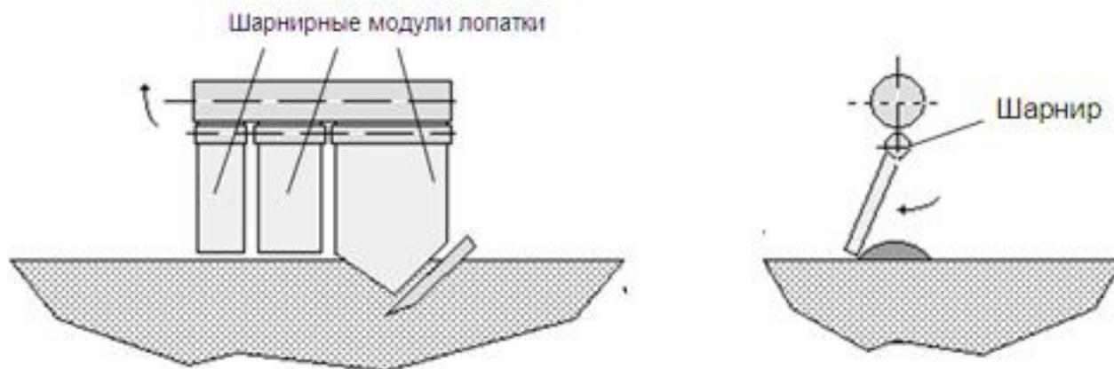
Рис.11. Шарнирное крепление лопаток к валу
