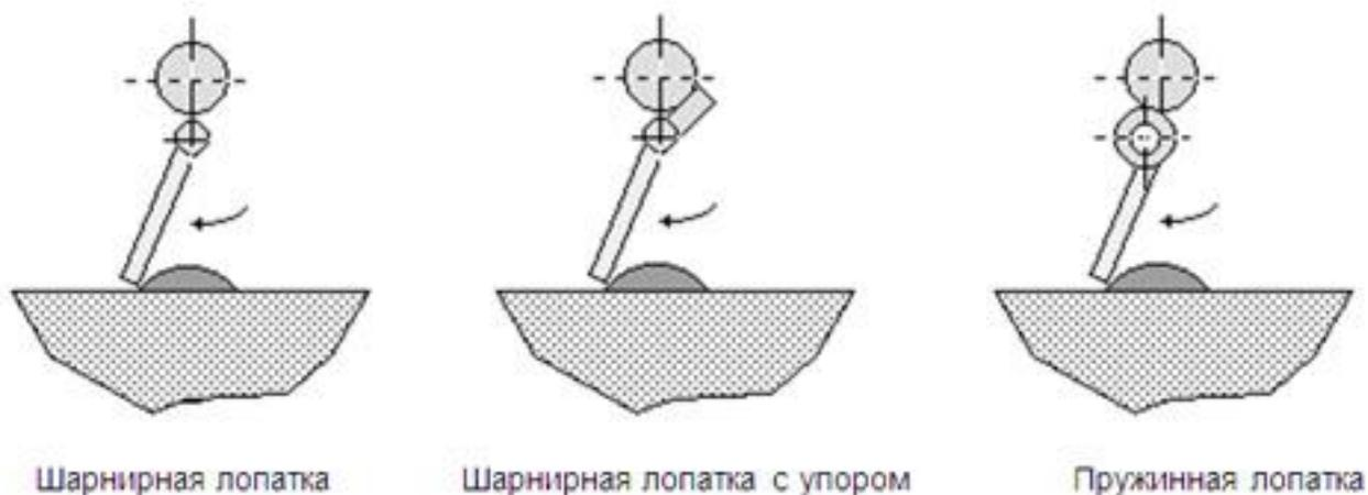
Рис.12. Варианты крепления лопаток к валу
